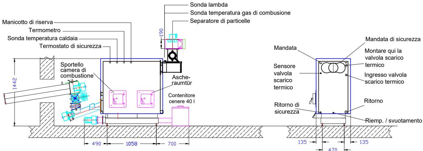
Il sistema di scarico fumi deve essere resistente alla condensa. In alcune circostanze può funzionare in condizioni umido/bagnato. La caldaia deve essere accessibile da tre lati. L'altezza della sala caldaia e la posizione del multiciclone/ separatore di particelle da definire dopo la consultazione con un tecnico specializzato Heizomat.
